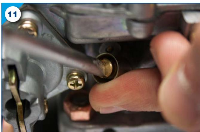
**6.** Réglez ensuite la vis butée de ralenti. Desserrez la vis butée de ralenti de manière à ce que celle-ci « effleure » la commande de starter (photo 12). Le gros plan de la photo 13 illustre le résultat à obtenir : un à deux filets doivent être apparents.
